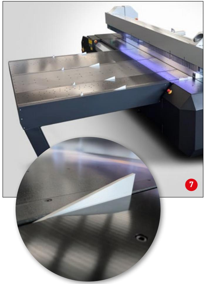
**I / 7.** Battuta elettronica Multi-Stop, completamente riprogettata per essere più efficiente e flessibile. Dotata di 4 stop basculanti a scomparsa, con interasse totale di 2000mm, apertura di 1300mm (2100mm a richiesta) e un'altezza di 39mm, per consentire il posizionamento di più pannelli sovrapposti. La funzione di esclusione automatica dei 4 stop, consente di liberare completamente il piano posteriore, direttamente dal fronte macchina.
