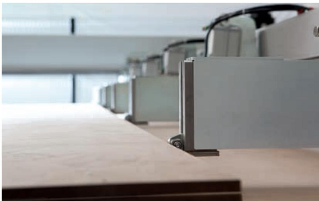
Les pinces prélèvent automatiquement la quantité nécessaire de panneaux sur la base du schéma d'usage, en augmentant ainsi l'efficacité et la fiabilité du centre de sciage, mais sans en augmenter l'encombrement.
