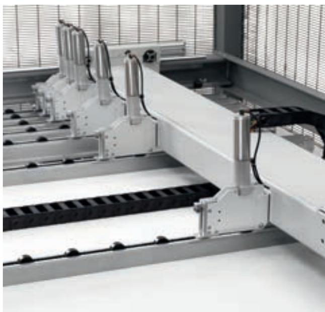
Positionnement minutieux et rapide des panneaux pour un maximum de précision de coupe grâce au chariot pousseur. Les pinces, indépendantes et autonivellantes, assurent une prise solide des panneaux et l'éjection complète des piles coupées hors de la ligne de sciage.
