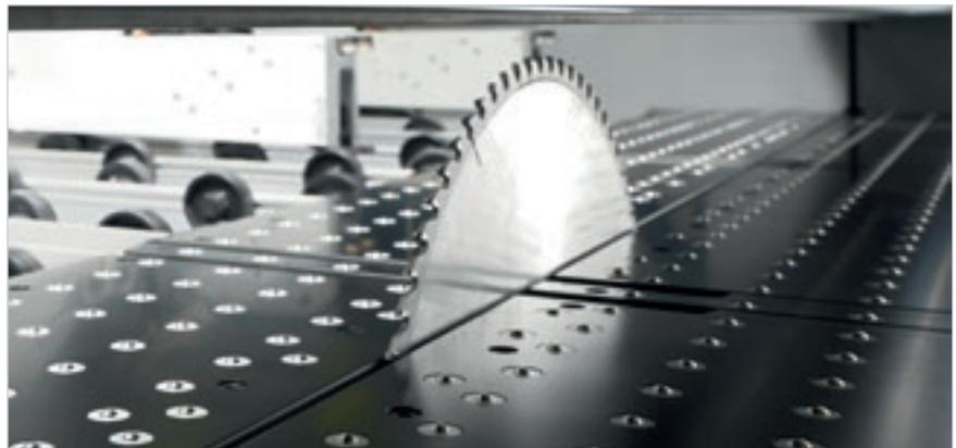
Qualité maximum du produit fini grâce à la table à coussin d'air pour le déplacement de matériaux délicats. Cette caractéristique garantit une propreté permanente de la table juste à côté de la lame.
