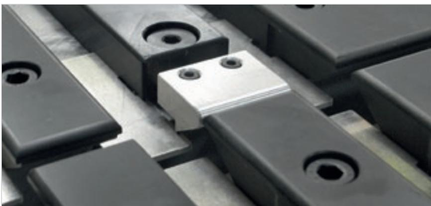
**Système de fermeture de la ligne de coupe** pour éviter la chute des déchets longitudinaux.
