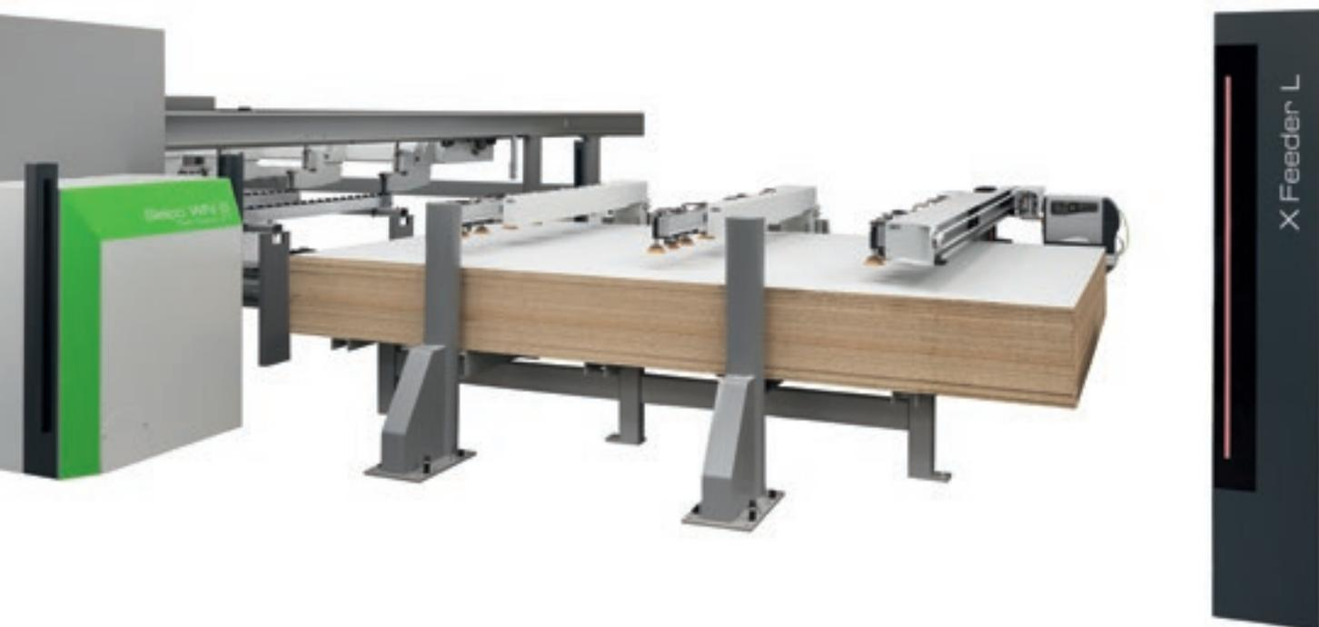
Détection automatique de la position du panneau en position de chargement pour un étiquetage bien effectué et précis.
