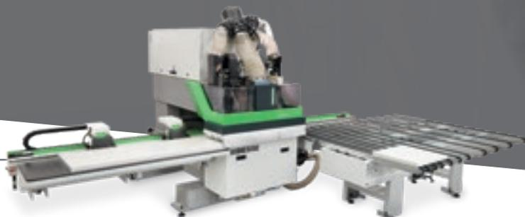
Skipper 100 est le centre d'usinage à contrôle numérique innovant capable de traiter en séquence des panneaux de différents formats en « temps réel ». C'est la machine idéale pour les ateliers d'usinage de hors mesure des grandes entreprises où la personnalisation devient de série, pour la production de petits lots en sous-traitance et pour ceux qui ont besoin d'une production flexible à flux tendus.
