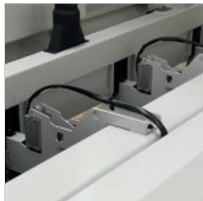
La pression homogène et contrôlée sur la pile de panneaux est garantie par le **presseur** à structure à élément simple.
