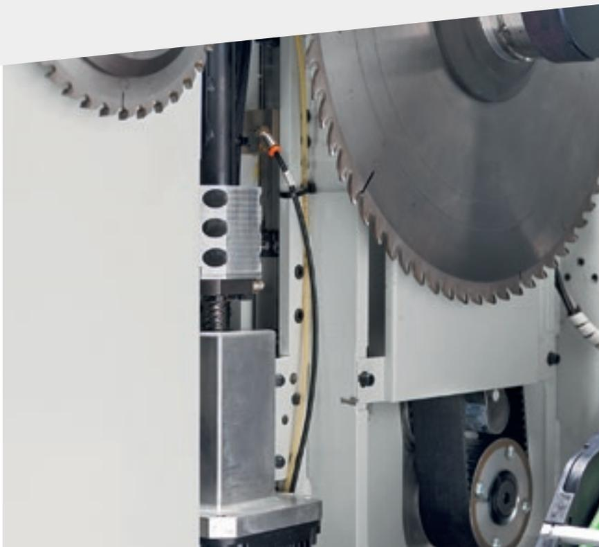
La **montée des lames** est gérée par moteur Brushless et par un système à vis à billes. Ce système garantit un réglage précis et rapide du dépassement de la lame.
