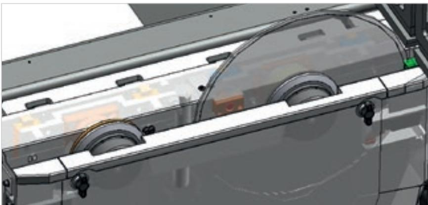
Le **dispositif anti-inclinaison** contrôle la position et le nombre de tours de la lame en intervenant sur la vitesse d'avancement. Qualité maximale de la coupe, augmentation de la durée de vie de la lame et coûts d'entretien réduits.
