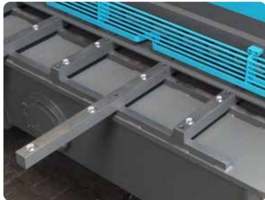
Trasferimenti a sfera montati nei blocchi del tavolo in ferro, per un facile inserimento delle lamiere.
