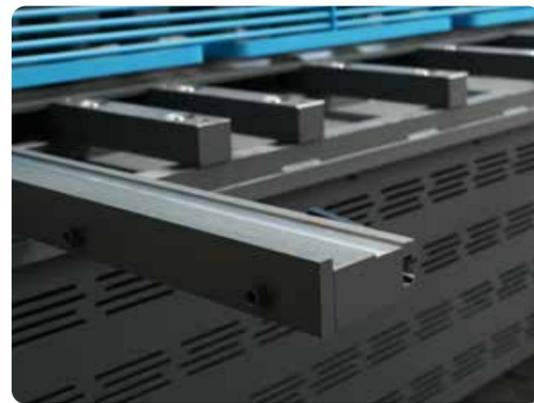
Bracci di squadatura e bracci di supporto frontali con o senza scala, scanalature a T e fermo inclinabile. Lunghezze da 1000 a 3000 mm.
