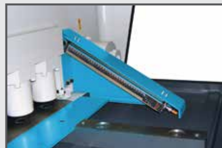
BARRIÈRE IMMATÉRIELLE devant les serre-tôles. BILLES DE MANUTENTION montées sur la table pour faciliter la manipulation des tôles.
