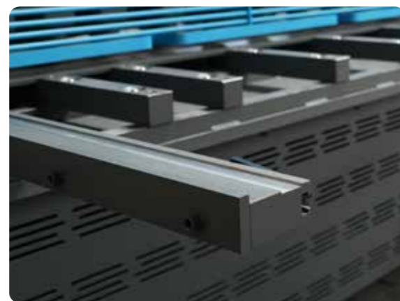
Butée d'équerrage et butées avant plus longues (1000 à 3000mm)
