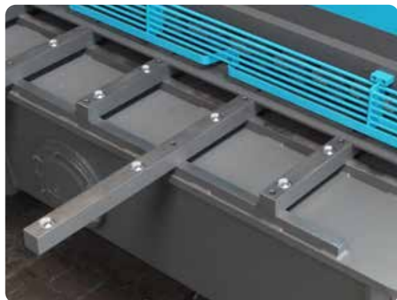
Console avant plus longue équipée de billes de manutention
