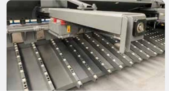
La butée arrière se compose de deux bras rigides (constitués de guidages linéaires et de vis à billes) et d'une cornière. Cette configuration assure un positionnement précis de la tôle, programmable avec le contrôle SC200. Affichage numérique de la position actuelle et présélection ou programmation de la position souhaitée.
