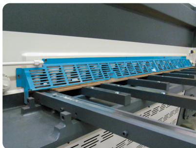
Butée d'équerrage et supports avant avec ou sans réglage, rainure en T et cliquet. Longueurs de 1000 à 3000 mm par longueur multiple de 500 mm.
