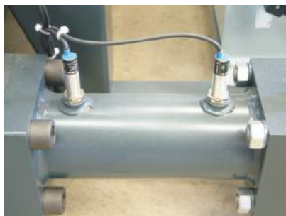
Cylindre de remplissage avec fin de course et trémie de remplissage étanche à la poussière
