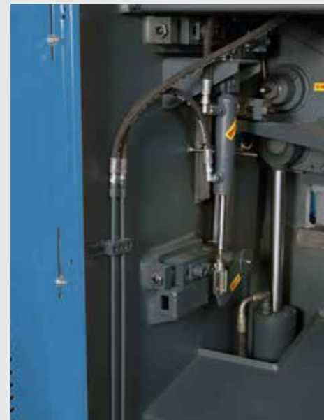
AUTOMATISCHE MESSPLEETREGELING (TSX) Automatische messpleetregeling in functie van de materiaaldikte door middel van 2 hydraulische cilinders.
