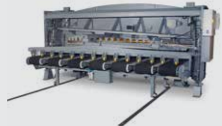
Schwerlastförderer und Blechstützsystem.
