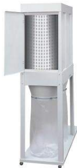
Versione con filtri a cartuccia. Filtering cartridges version. Version avec cartouches de filtration. Ausführung mit Filterpatronen.
