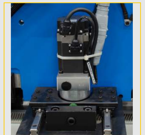
AC servo motorisatie d.m.v. planetaire overbrenging en spiraalvormige tandheugel aandrijving
